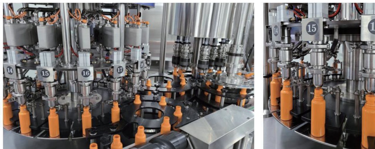
フローメーターを適用した定量および衛生充填設備
